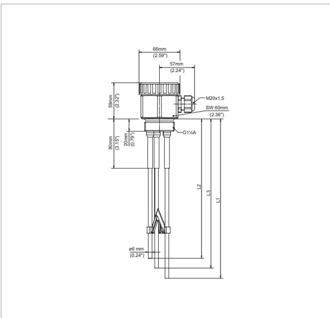
Sonda de medición conductiva EL 3
