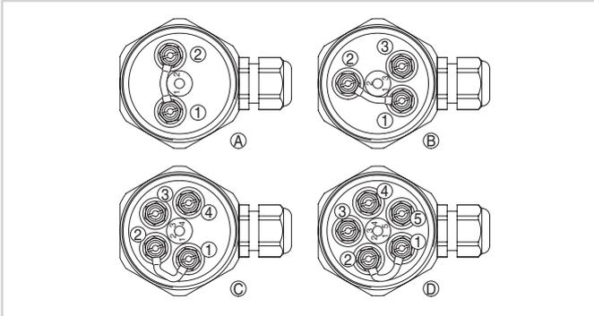
Anschlussraum der Messsonde - 220 k $\Omega$ -Widerstand zwischen den Klemmen 1 und 2
