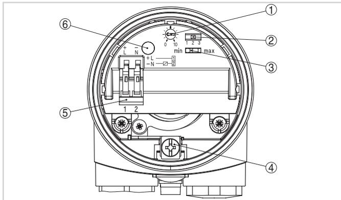
Pieza electrónica recambiable - interruptor sin contactos
