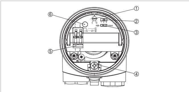
Sistema eletrônico - interruptor sem contato
