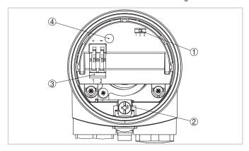
Pieza electrónica recambiable - Salida de dos conductores
