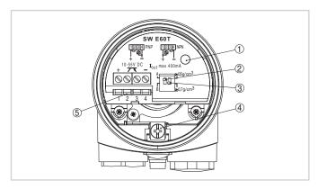
Elektronik- und Anschlussraum Einkammergehäuse
