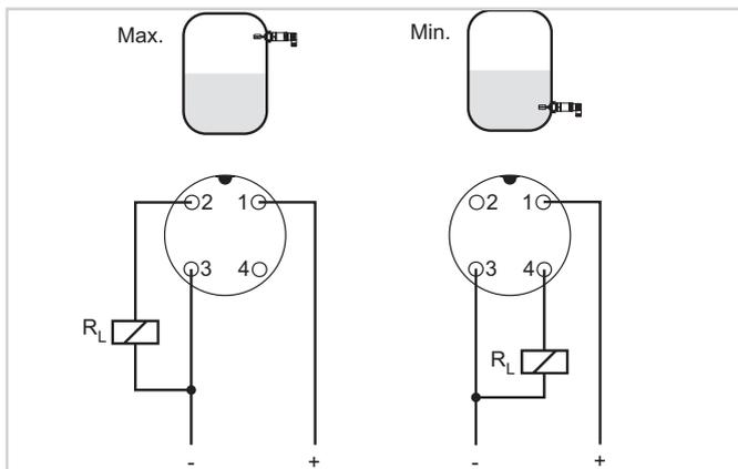
VEGASWING 51 con conexión de enchufe M12 x 1
