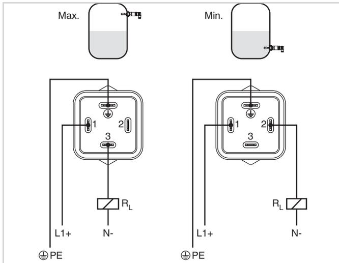
VEGASWING 51 con enchufe de válvula según DIN 4400
