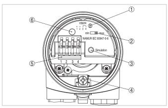
Compartimiento de la electrónica y de conexiones - Salida NAMUR
