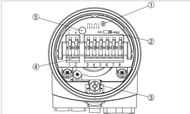
Compartimento do sistema eletrônico e de conexão - Saída de relé
