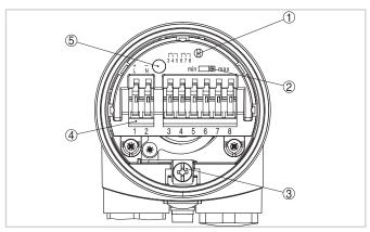
Compartiment électronique et de raccordement - sortie relais
