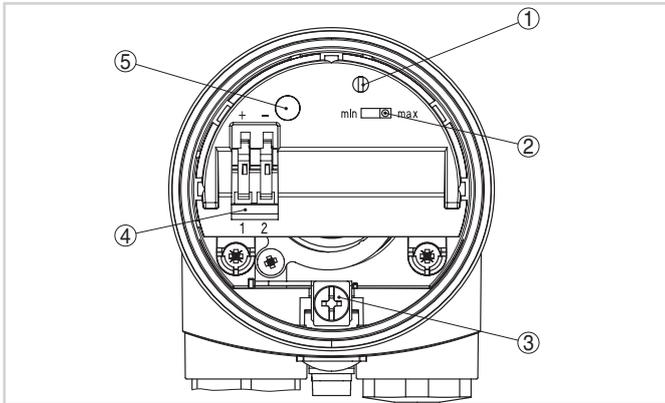
Compartimento do sistema eletrônico e de conexão - Saída de dois condutores
