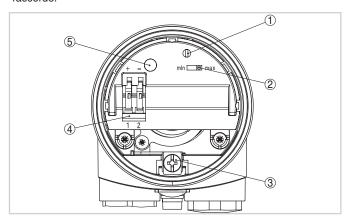
Compartiment électronique et de raccordement - sortie bifilaire
