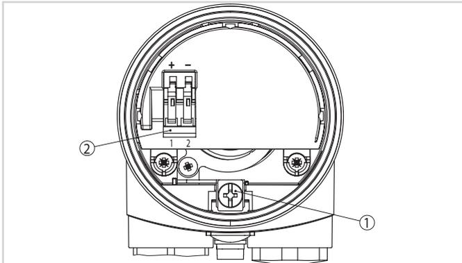
Compartiment électronique et de raccordement boîtier à chambre unique
