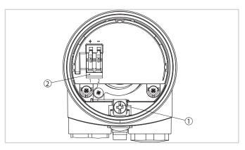
Elektronik- und Anschlussraum Einkammergehäuse
