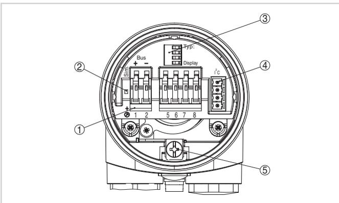
Elektronik- und Anschlussraum Einkammergehäuse
