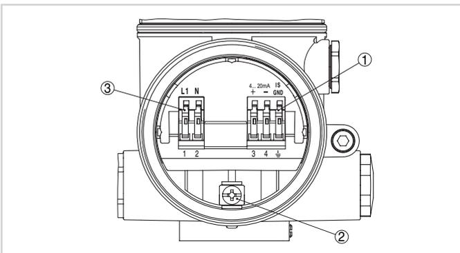
Compartimiento de conexión carcasa de dos cámaras
