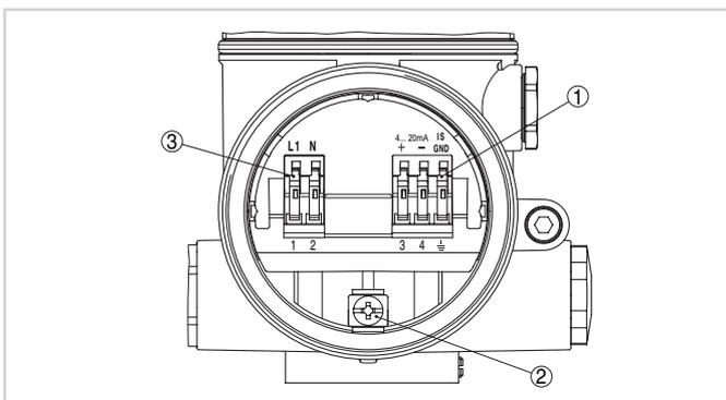
Compartiment de raccordement boîtier à deux chambres
