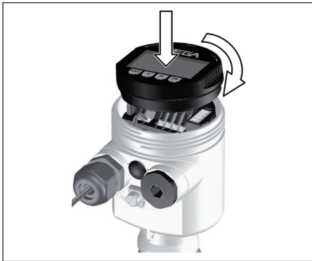
Fig. 26: Montaje del módulo de indicación y ajuste
