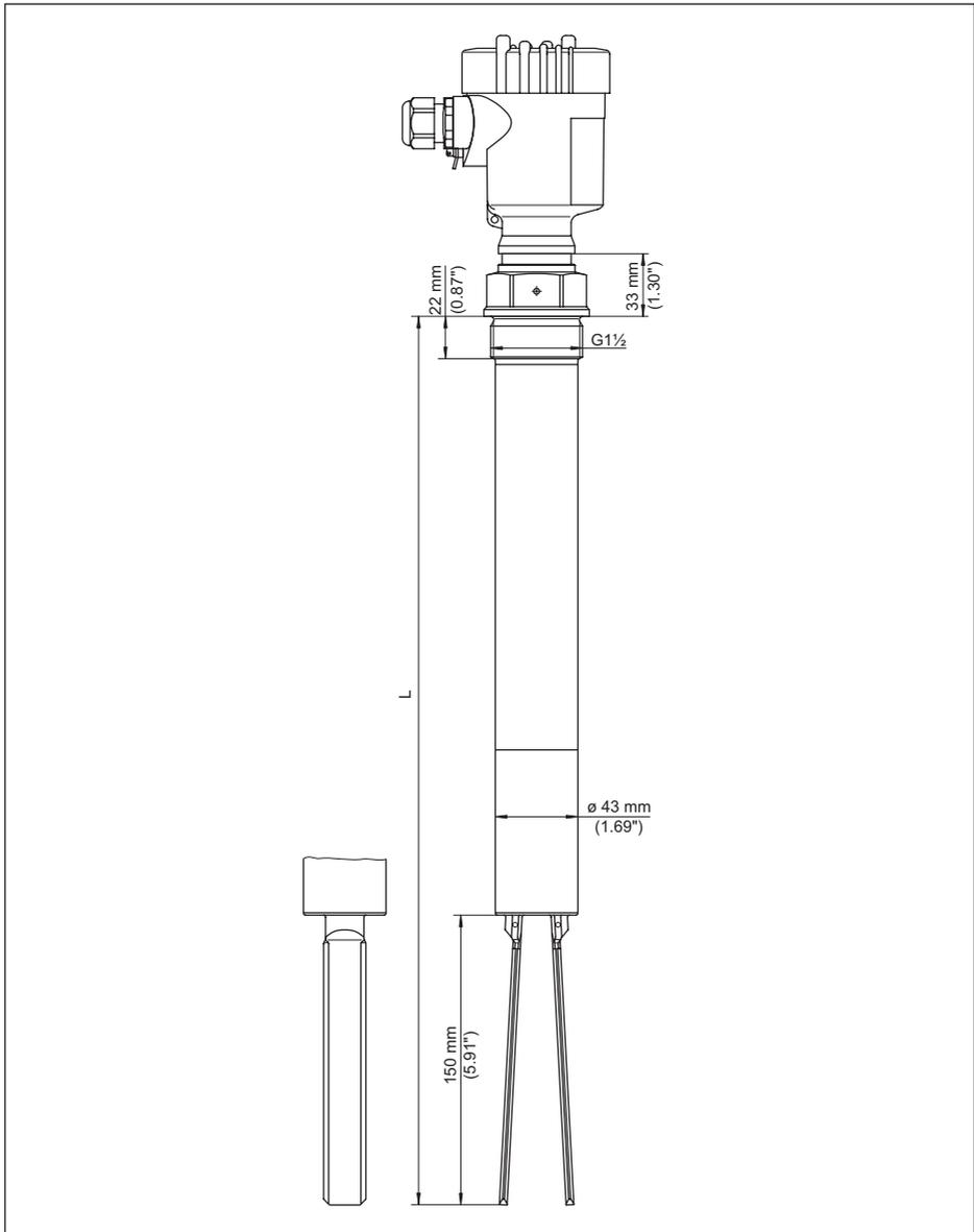
Abb. 20: VEGAWAVE 63, Gewindeausführung G1½ (DIN ISO 228/1)
