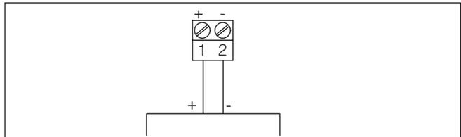
Abb. 10: Anschlussplan Einkammergehäuse
