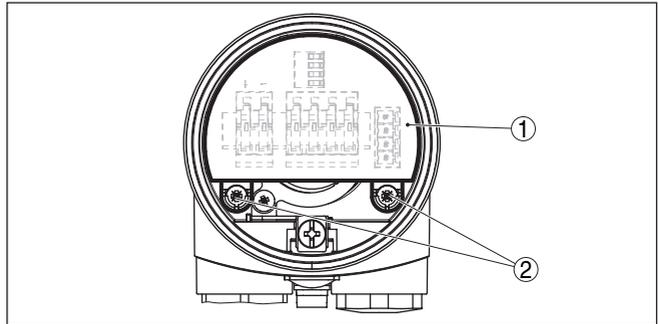
Abb. 15: Halteschrauben lösen
