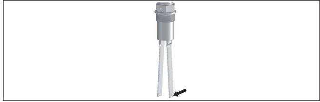
Fig. 16: Charge maximale latérale le long du côté des lames (côté étroit des lames)
