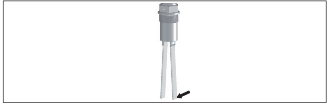
Fig. 13: Charge maximale latérale le long du côté des lames (côté étroit des lames)
