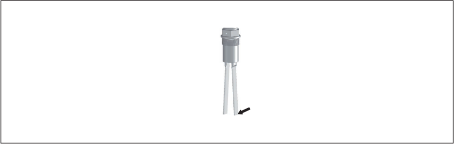
Abb. 15: Maximale seitliche Belastung längs zur Gabelseite (schmale Gabelseite)
