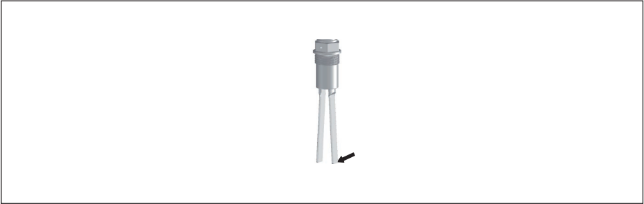
Abb. 16: Maximale seitliche Belastung längs zur Gabelseite (schmale Gabelseite)
