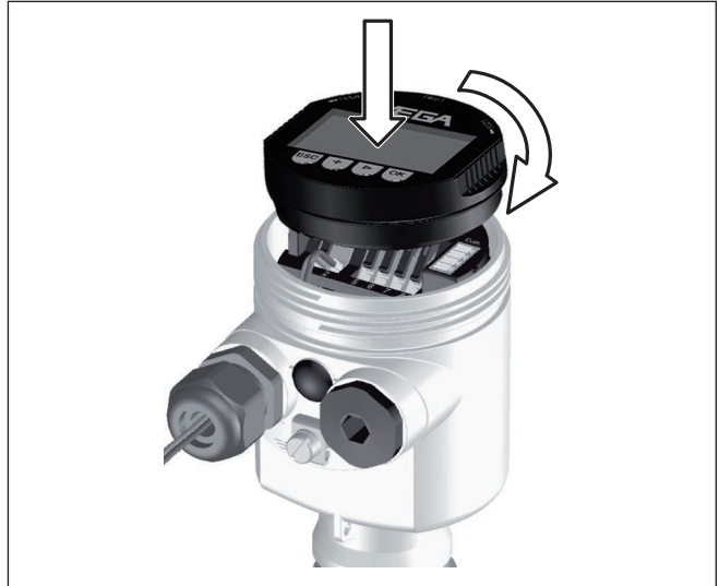
Fig. 4: Insertion du module de réglage et d'affichage
