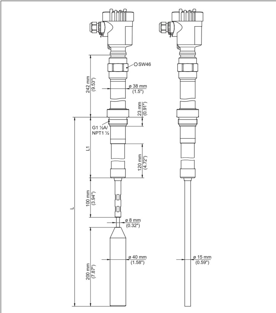
Abb. 19: VEGACAP 67, Gewindeausführung G1 1/2 (ISO 228 T1) und 1 1/2 NPT, -50 ... +300 °C (-58 ... +572 °F)
