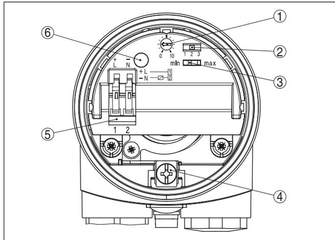
Abb. 12: Elektronikeinsatz - kontaktloser Schalter
