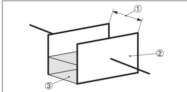
Abb. 3: Funktionsprinzip - Plattenkondensator
