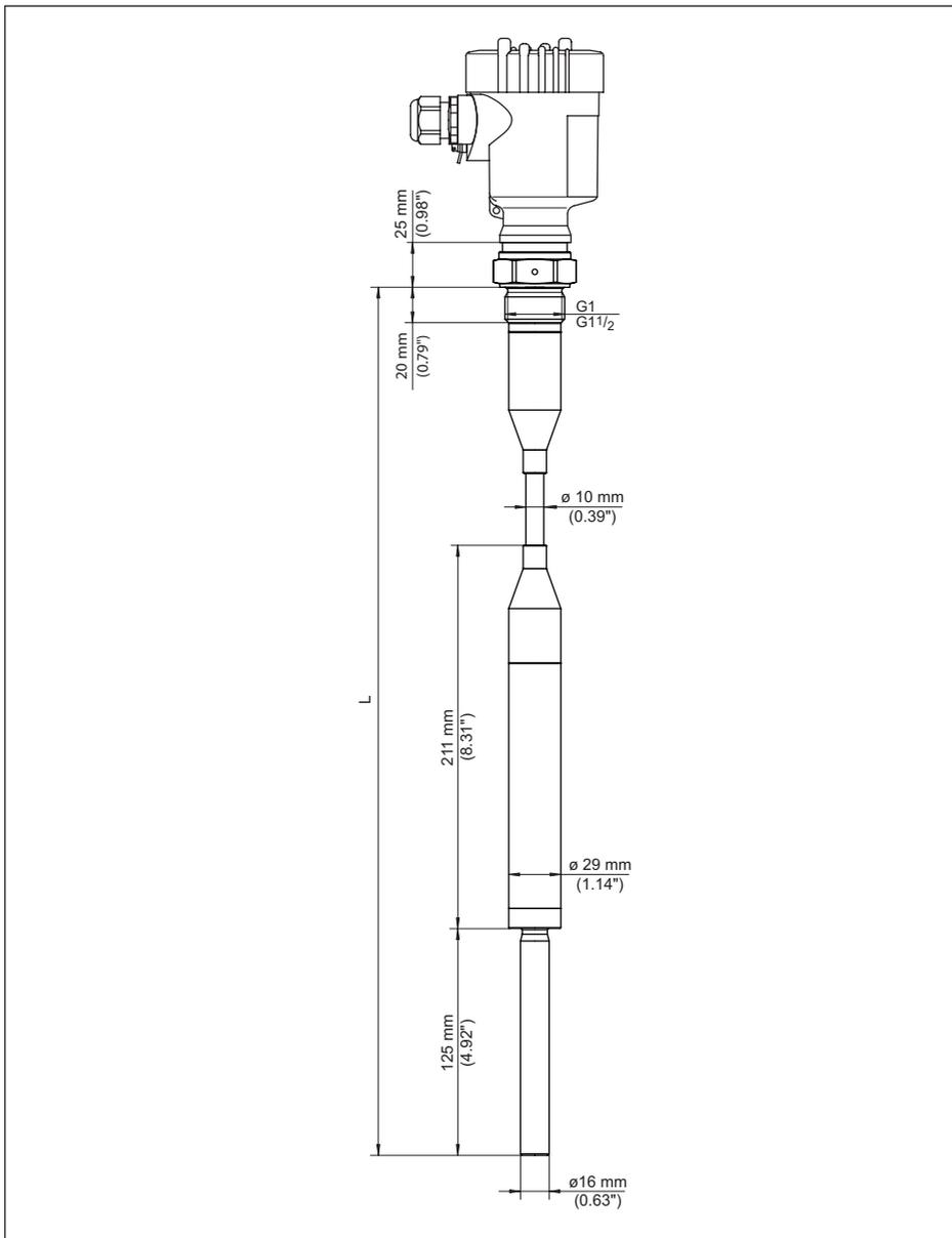
Figura 18: VEGAVIB 62 con cavo portante FEP
