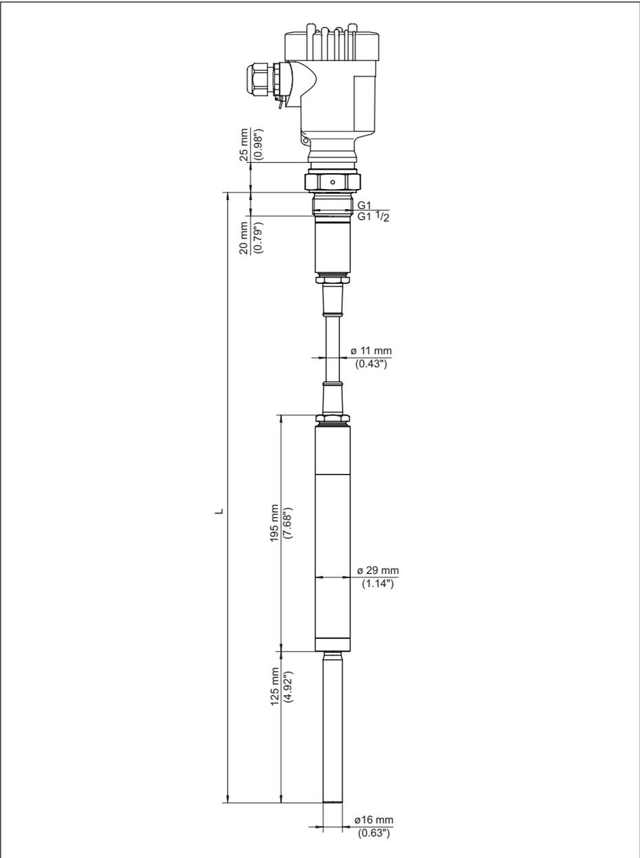
Figura 17: VEGAVIB 62 con cavo portante PUR
