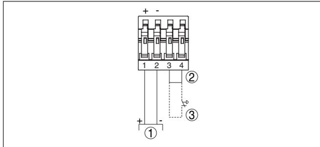
Figura 10: Schema elettrico - Tasto esterno di simulazione
