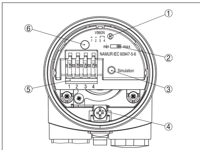
Figura 12: Vano dell'elettronica e di connessione - Uscita NAMUR
