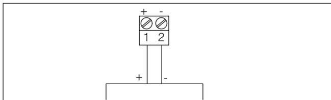
Figura 9: Schema di collegamento custodia a una camera
