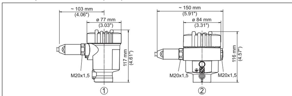
Fig. 19: Variantes de boîtier en protection IP66/IP68 (1 bar)
