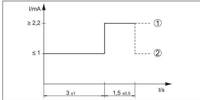
Fig. 14: Diagramme de déroulement du test de fonctionnement - fonction de commutation conformément à l'état de recouvrement et sélection de courbe caractéristique (voir tableau des fonctions)
