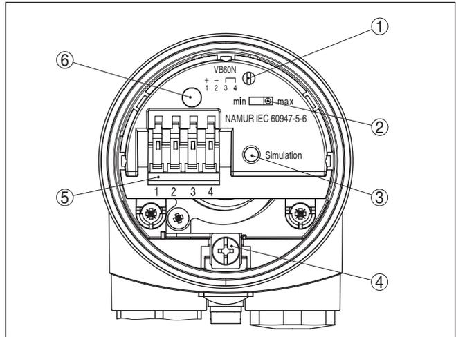
Fig. 13: Compartiment électronique et de raccordement - sortie NAMUR
