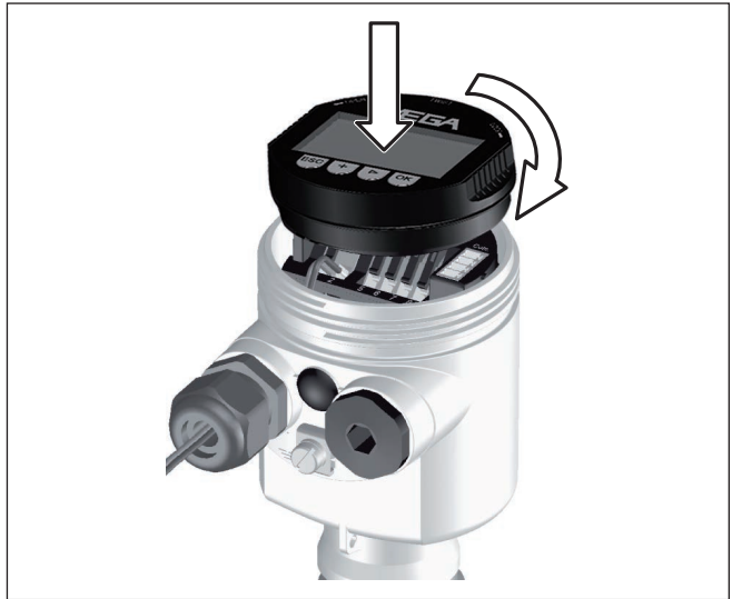
Rys. 20: Wkładanie modułu wyświetlającego i obsługowego do obudowy jednokomorowej
