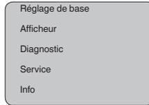
2. Sélectionner le point de menu " *Réglage de base*" avec **[->]** et confirmer avec **[OK]**. Le point de menu " *Réglage min.*" apparaît ensuite.
