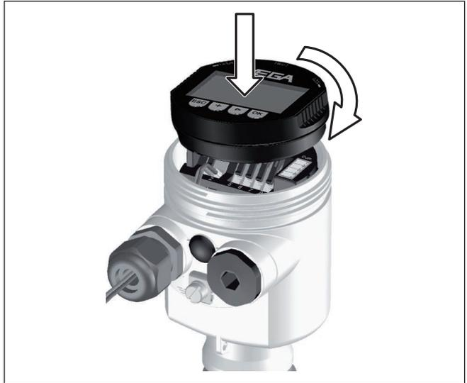
Fig. 20: Insérer le module de réglage et d'affichage dans le boîtier à une chambre
