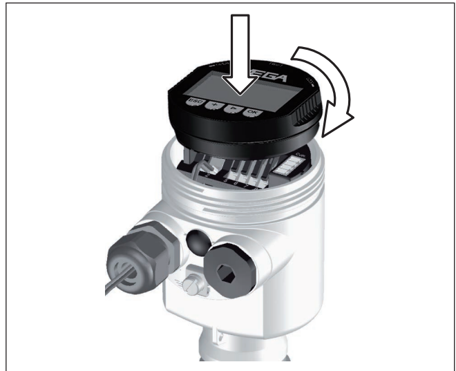
Abb. 20: Anzeige- und Bedienmodul im Einkammergehäuse einsetzen
