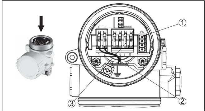
Fig. 12: Compartiment électronique - boîtier à deux chambres
