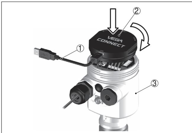
Fig. 22: Raccordement du PC directement au capteur via l'adaptateur d'interface VEGACONNECT
