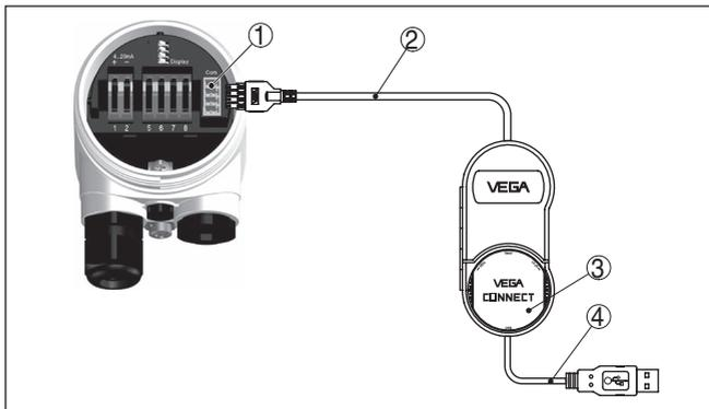
Fig. 23: Raccordement via l'adaptateur d'interface VEGACONNECT externe
