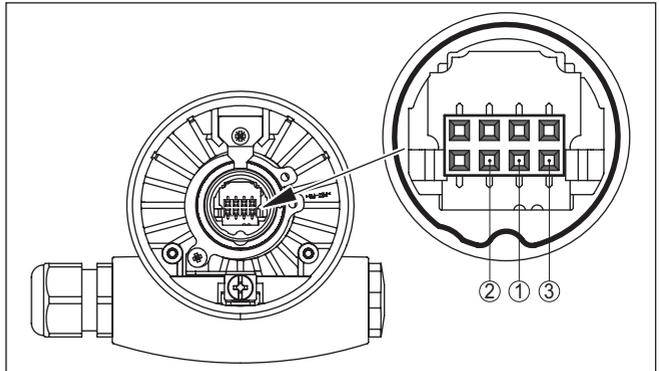
Fig. 28: Vérifier la résistance à l'intérieur de la sonde
