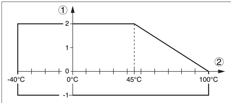
Fig. 29: Pression process - température process (bride en PTFE)
