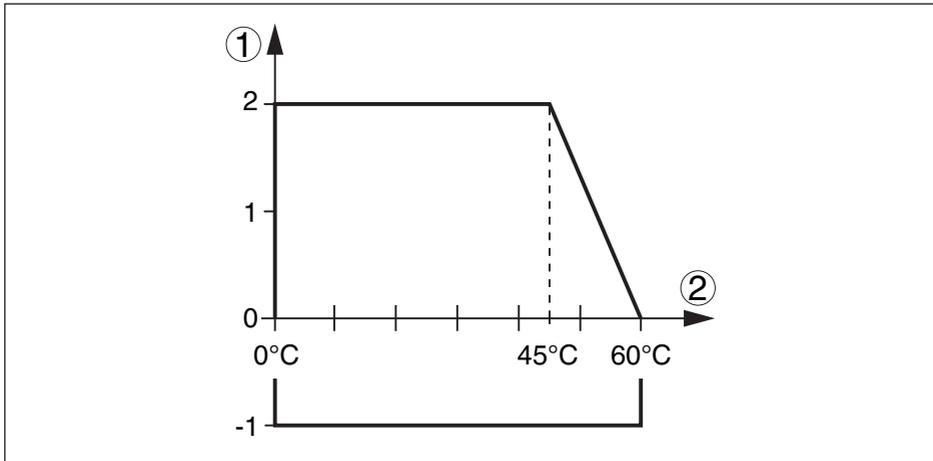
Fig. 30: Pression process - température process (bride en PP)
