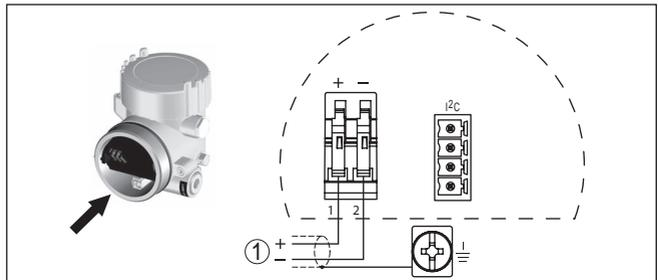
Fig. 14: Schéma de raccordement - boîtier à deux chambres
