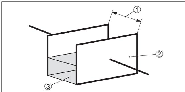
Figura 3: Principio di funzionamento - Condensatore a piastre
