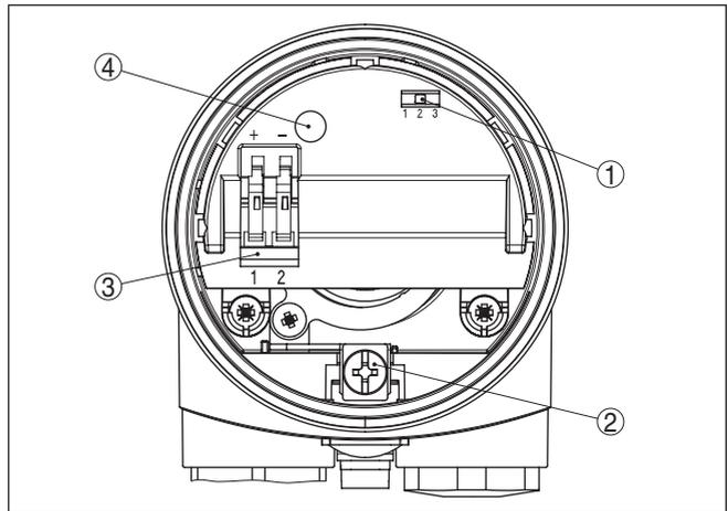
Figura 12: Unità elettronica - Uscita bilare
