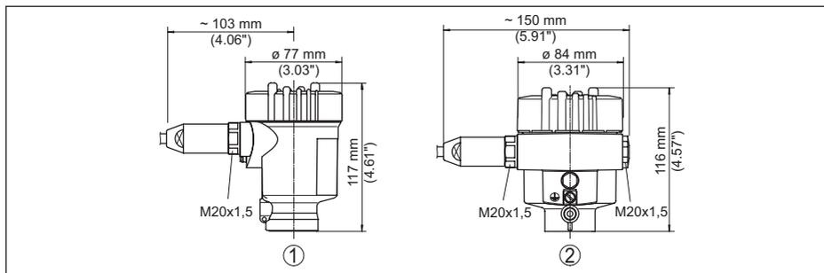
Figura 21: Differenti custodie con grado di protezione IP66/IP68 (1 bar)
