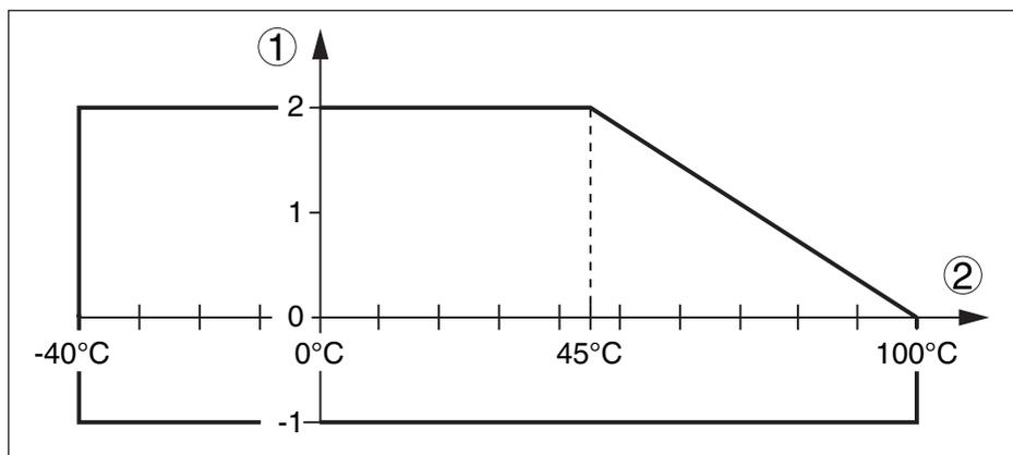
Figura 18: Pressione di processo - Temperatura di processo (flangia di PTFE)
