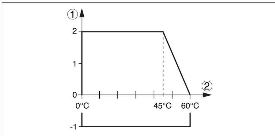
Figura 19: Pressione di processo - Temperatura di processo (flangia di PP)
