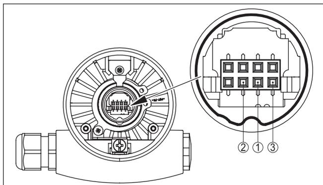
Fig. 11: Verificar a resistência dentro da sonda de medição
