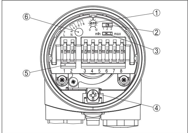
Fig. 8: Compartimento do sistema eletrônico e de conexão
