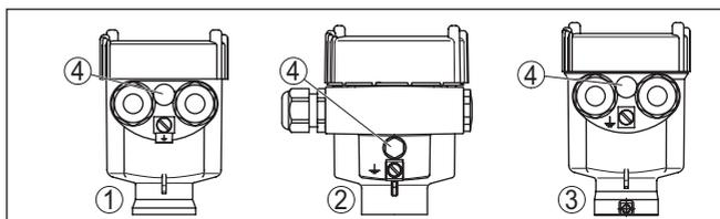
Fig. 7: Tipos de material - caixa de uma câmara
