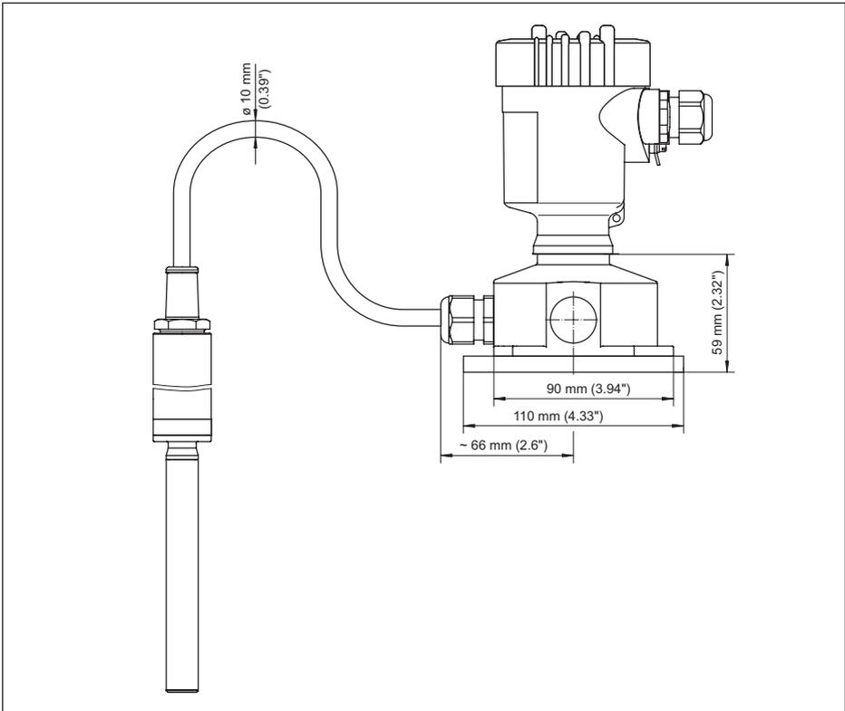
Fig. 8: Boîtier externe avec départ de câble direct vers l'élément vibrant
