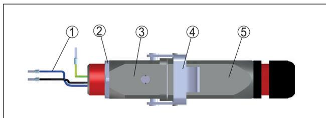
Fig. 1: Structure du connecteur Harting HAN 8D - Exemple version droite
