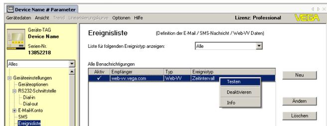
Abb. 34: Ereignisliste zur Einrichtung der Messwertübertragung
