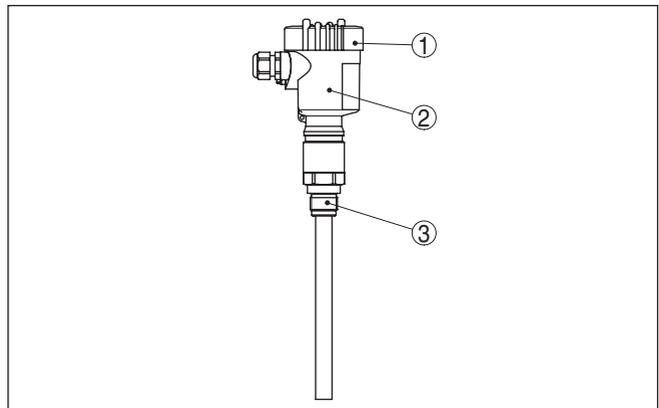
Fig. 1: VEGACAL 64, version à tige avec boîtier plastique
