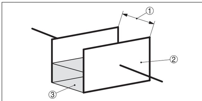
Fig. 3: Principe de fonctionnement - condensateur à plaques
