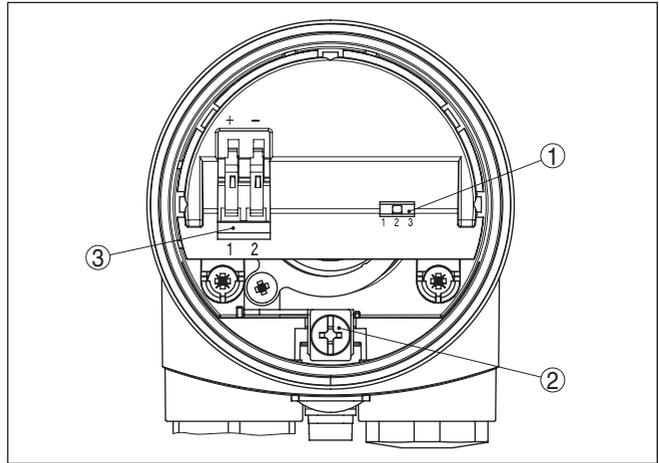
Fig. 13: Éléments de réglage et d'affichage - électronique
