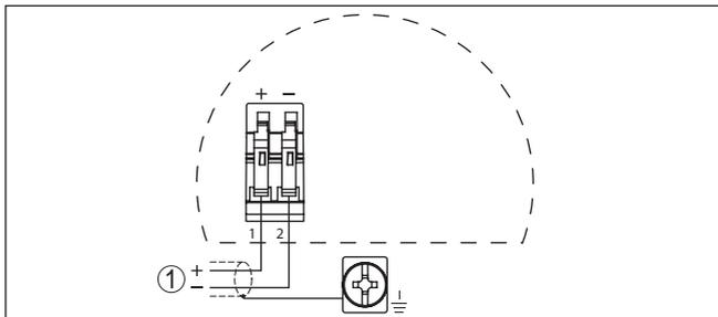
Fig. 11: Schéma de raccordement - boîtier à chambre unique
