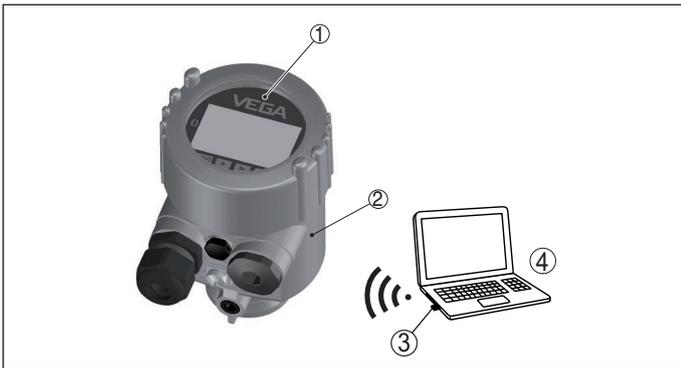
Fig. 29: Raccordement du PC via un adaptateur Bluetooth-USB
