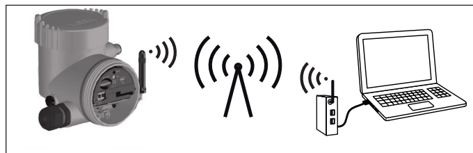
Fig. 33: Transmissão de valores de medição e parametrização remota do sensor pela rede de telefonia celular
