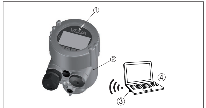
Abb. 29: Anschluss des PCs via Bluetooth-Adapter
