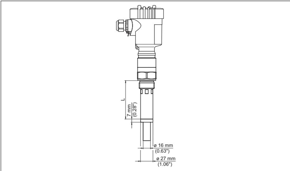
Figura 34: VEGACAL 66, tubo schermante per es. contro la forte formazione di condensa
