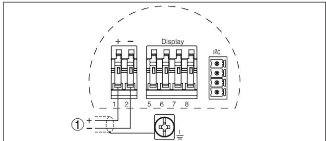
Figura 11: Schema di allacciamento - custodia a una camera
