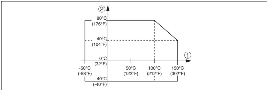
Figura 28: Temperatura ambiente - Temperatura di processo
