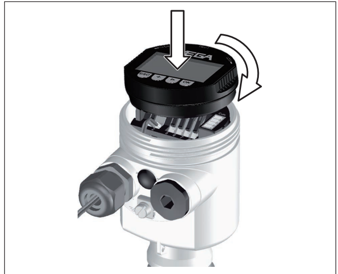
Abb. 21: Anzeige- und Bedienmodul im Einkammergehäuse einsetzen
