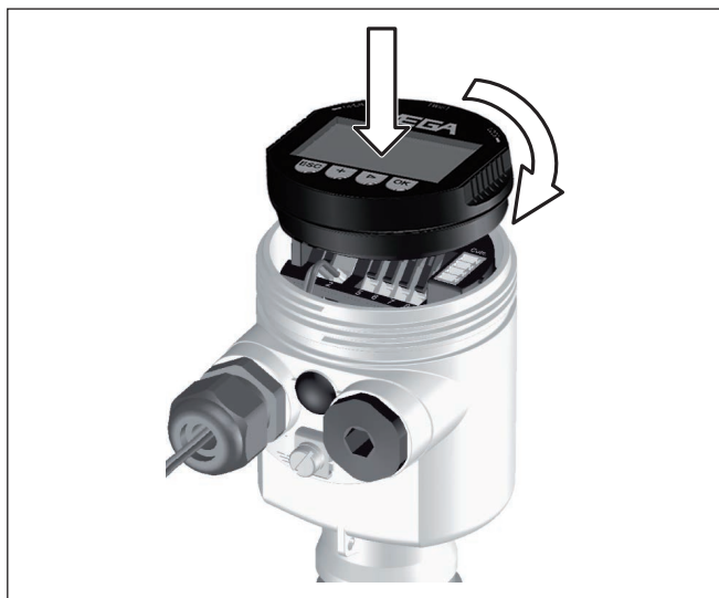
Rys. 21: Wkładanie modułu wyświetlającego i obsługowego do obudowy jednokomorowej
