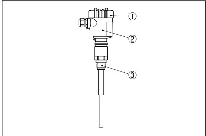
Fig. 1: VEGACAL 62, version à tige avec boîtier plastique
