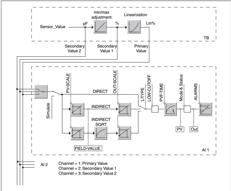
Fig. 29: Traitement des valeurs de mesure VEGACAL 62
