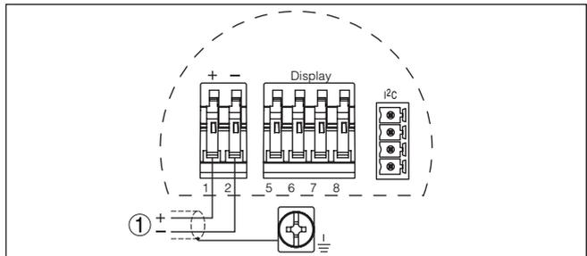
Fig. 11: Schéma de raccordement - boîtier à chambre unique
