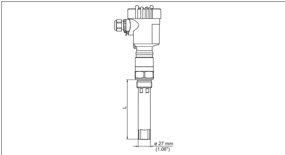
Fig. 36: VEGACAL 62, tube de référence, p. ex. si faible constante diélectrique ou pour linéarisation
