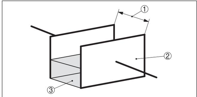
Abb. 3: Funktionsprinzip - Plattenkondensator
