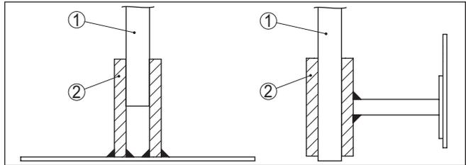
Abb. 6: Messsonde fixieren
