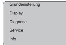
2. Den Menüpunkt "Grundeinstellung" mit **[->]** auswählen und mit **[OK]** bestätigen. Nun wird der Menüpunkt "Min.-Abgleich" angezeigt.
