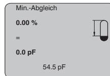
3. Mit **[OK]** den Abgleichwert zum Editieren vorbereiten. Mit **[OK]** in das Auswahlfenster wechseln.
