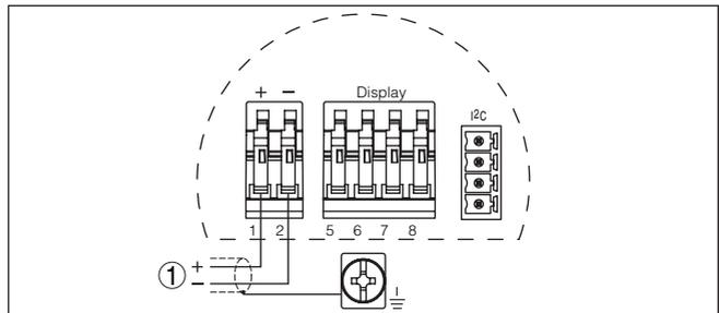
Abb. 11: Anschlussplan - Einkammergehäuse
