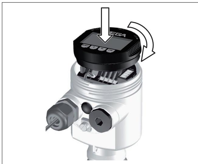
Fig. 21: Insérer le module de réglage et d'affichage dans le boîtier à une chambre
