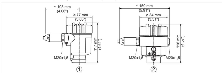
Fig. 23: Modelos da caixa com proteção IP66/IP68 (1 bar)
