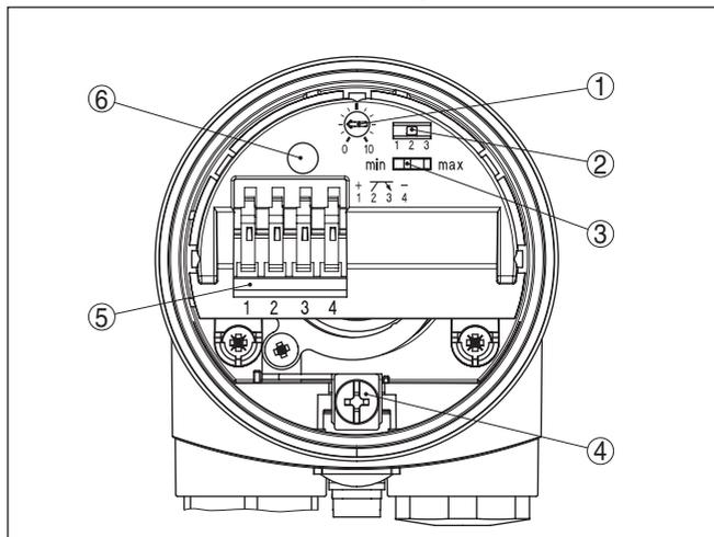
Fig. 15: Sistema eletrônico - saída do transistor
