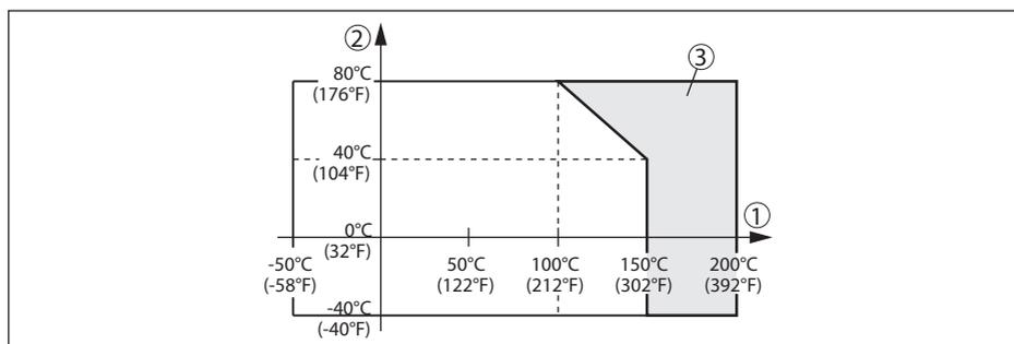
Fig. 21: Temperatura ambiente - temperatura do processo
