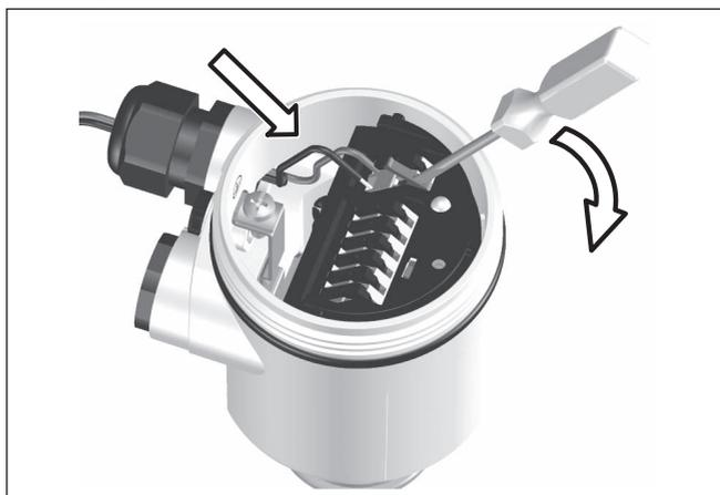
Fig. 8: Passos 5 e 6 do procedimento de conexão
