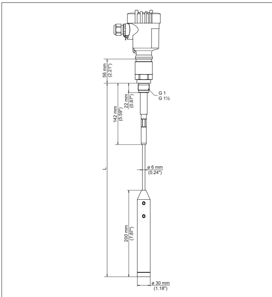
Fig. 24: VEGACAP 65, Modelo com cabo com  $\varnothing$  6 mm (0.236 in), modelo com rosca G1 (ISO 228 T1)
