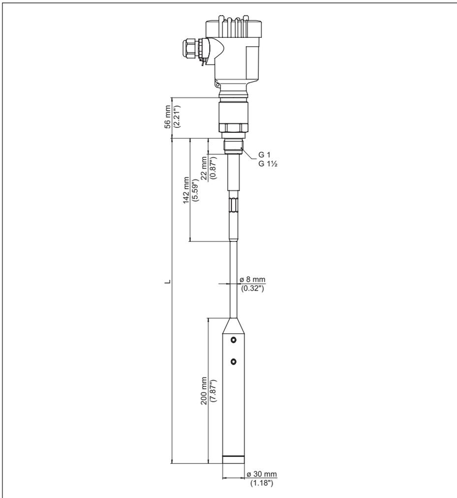
Fig. 25: VEGACAP 65, Modelo com cabo com  $\varnothing$  8 mm (0.315 in), modelo com rosca G1 (ISO 228 T1)
