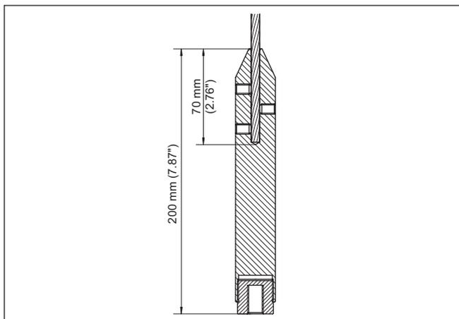
Fig. 19: Levando o peso tensor em consideração e encurtando devidamente o cabo de aço
