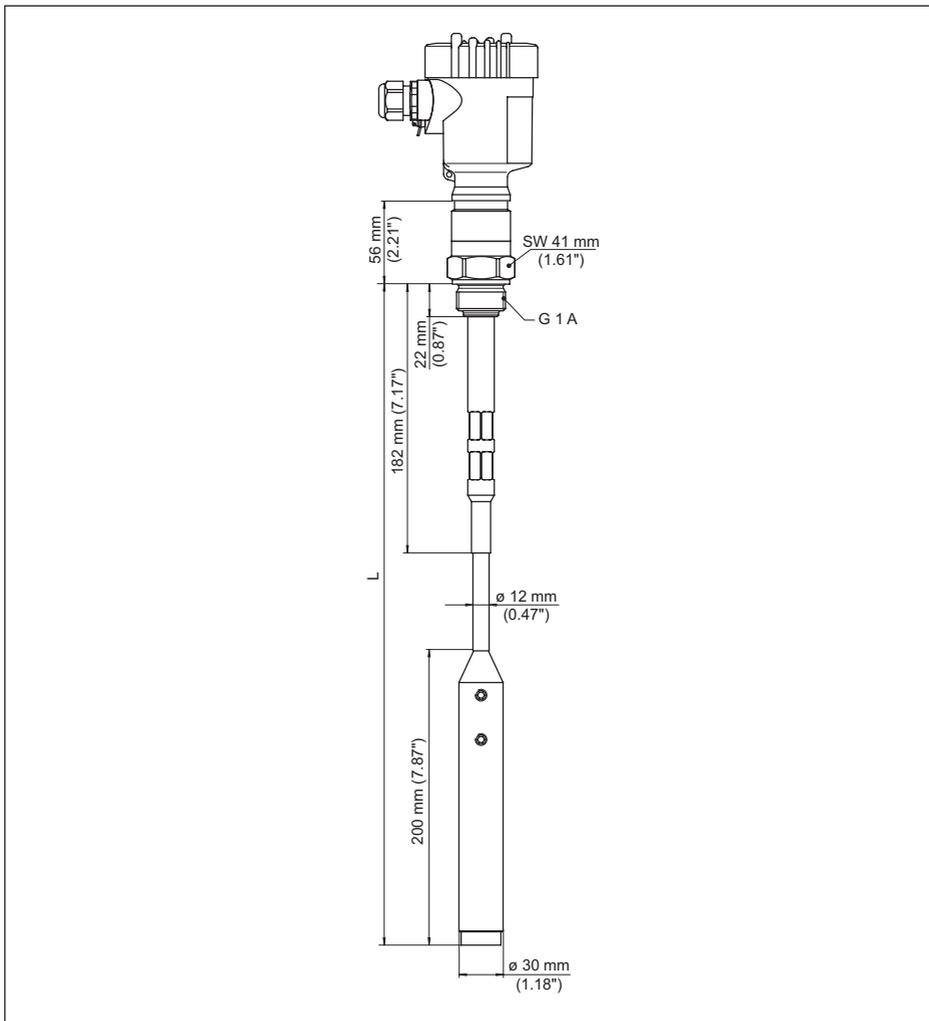
Figura 22: VEGACAP 65, esecuzione a fune con  $\varnothing$  12 mm (0.472 in), esecuzione filettata G1 (ISO 228 T1)
