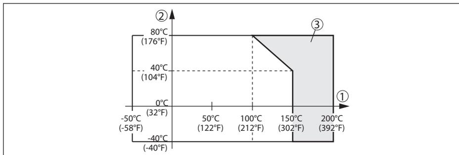
Figura 18: Temperatura ambiente - Temperatura di processo
