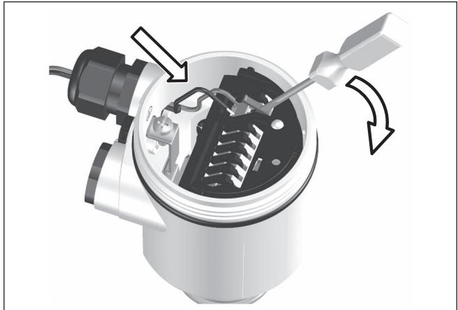
Figura 8: Operazioni di collegamento 5 e 6
