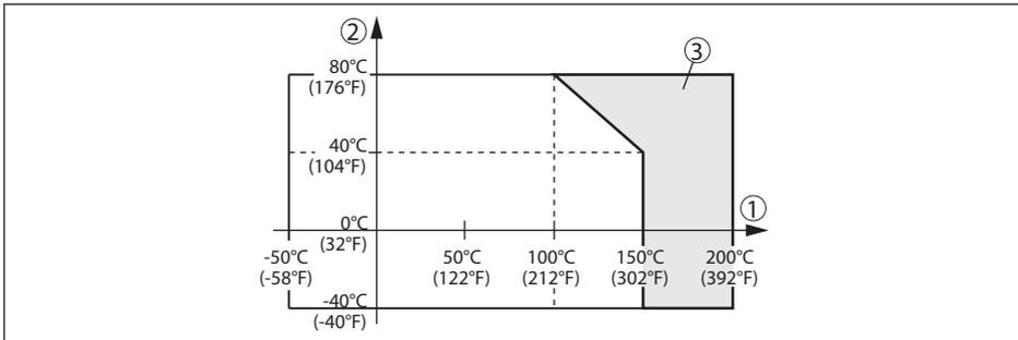
Fig. 15: Temperatura ambiente - Temperatura de proceso
