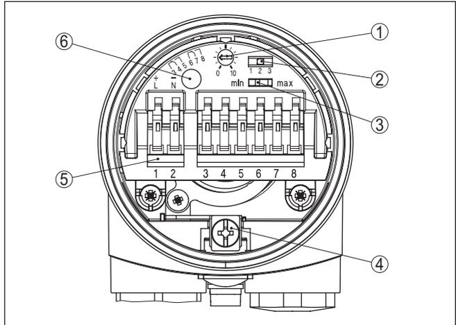
Fig. 9: *Compartimento de la electrónica y de conexiones*
